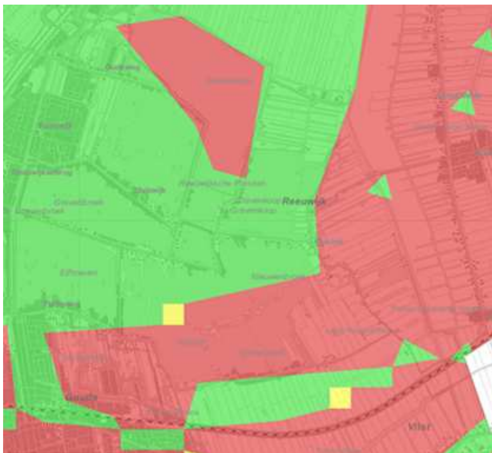
Figuur 3-6 Kwel- en wegzijging in en rond het Natura 2000-gebied Broekvelden, Vettenbroek en Polder Stein (groen: infiltratie; rood: kwel) (Geoweb, Provincie Zuid-Holland)
